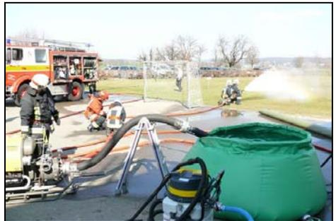
Aufbau mit Löschbecken und Motorspritze. Auf diese Art könnte auch Löschwasser aus einem Pool bezogen werden. Im Hintergrund das Tanklöschfahrzeug.
