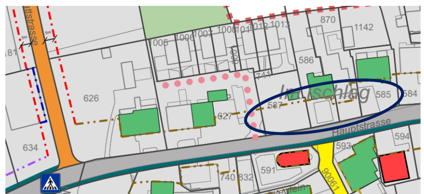
Abbildung 41: Anpassung der Gestaltungsbaulinien entlang der Hauptstrasse
